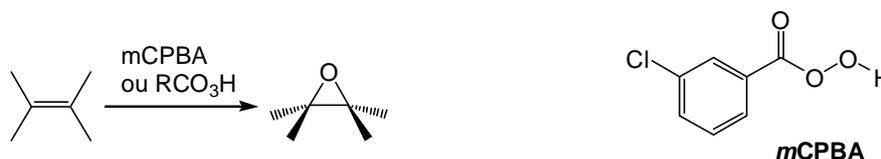
Si il y a plusieurs oléfines (doubles liaisons) dans une molécule, et que l'on met seulement 1 équivalent de mCPBA, alors c'est l'oléfine la plus riches en électrons qui sera époxydée.
